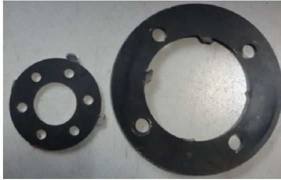
شکل ۱۸: گسیختگی صفحه برش ایمنی در دروگرهای بشقابی
