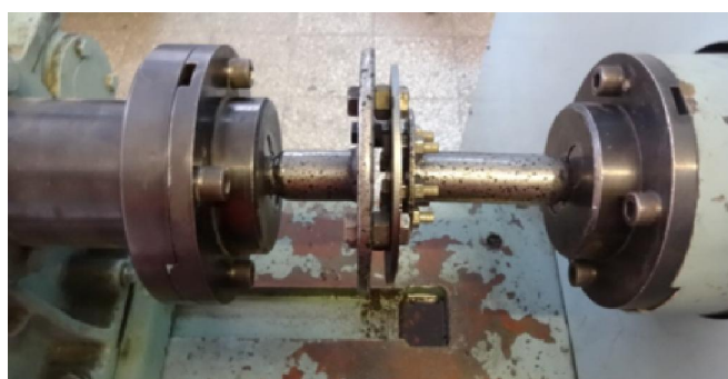
شکل ۸: فیکسچر ساخته شده برای تست پیچش صفحه برش ایمنی در دروگرهای بشقابی
